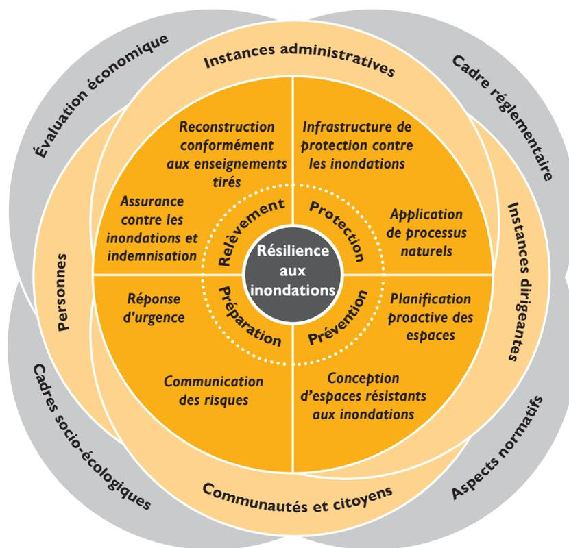
**Figure 6 :** « L'Augmentation de la résilience aux inondations » est un outil de gestion pour promouvoir la transformation vers la résilience aux inondations. La résilience aux inondations peut être augmentée en concrétisant l'approche de sécurité multicouche (niveau 1, jaune) dans le contexte institutionnel (niveau 2, jaune pâle). Les deux sont intégrés dans le contexte plus large (niveau 3, gris pâle). Karrasch et al, 2021.
